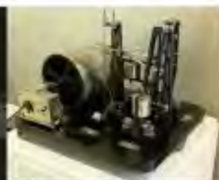
〔国立科学博物館と岐阜県立博物館にだけ残る今村式2倍強震計の実物（岐阜県立博物館で武村撮影、2022）〕
