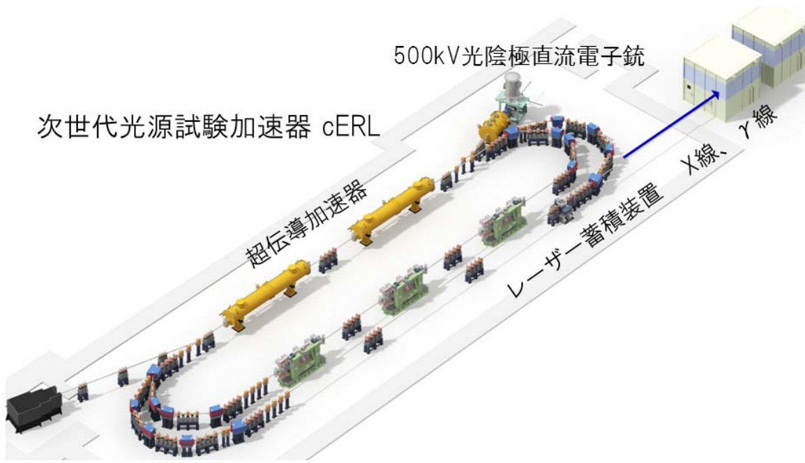
図4：高エネルギー加速器研究機構で建設中の次世代光源試験加速器 cERL。500kV 光陰極直流電子銃、超伝導加速器など次世代光源に必要な開発要素装置群で構成されている。レーザー蓄積装置と相対論的電子ビームとのコンプトン散乱による高輝度X線、 \gamma 線源としての利用も計画されている。
