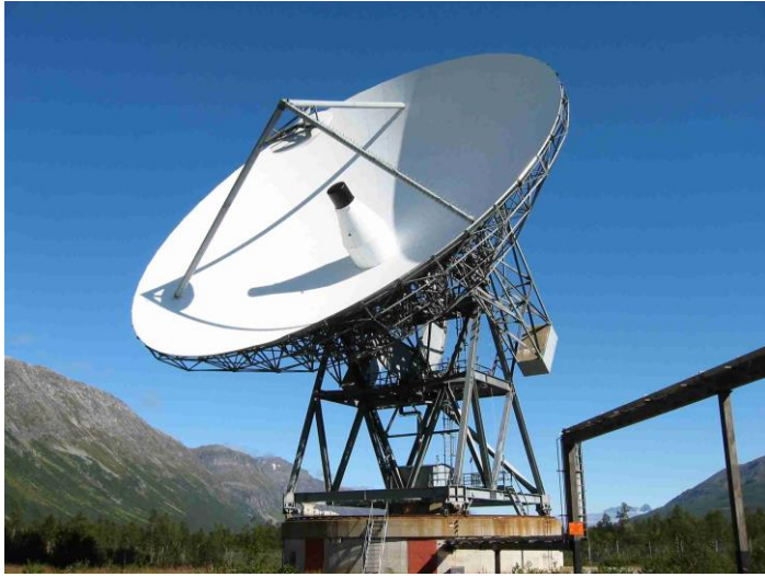
図1：EISCAT UHF レーダー（ノルウェー・トロンソ）の外観。直径 32 m のパラボラ型アンテナと約 1.5 MW の送信電波出力を用いた観測を 33 年間に渡り継続している。
