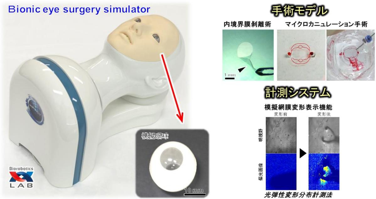
図1 眼科手術シミュレーションシステムの概要 (左) 眼科手術シミュレータの外観と模擬眼球 (右) 現在搭載可能な手術モデルと計測システム
