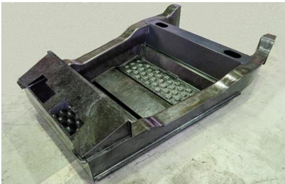
図1 製作に成功したオール熱可塑性CFRPシャシー
