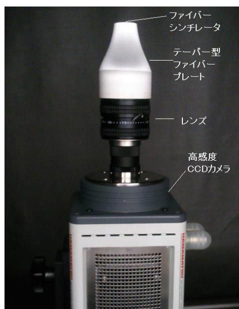
図1 開発した放射線画像化装置の写真
