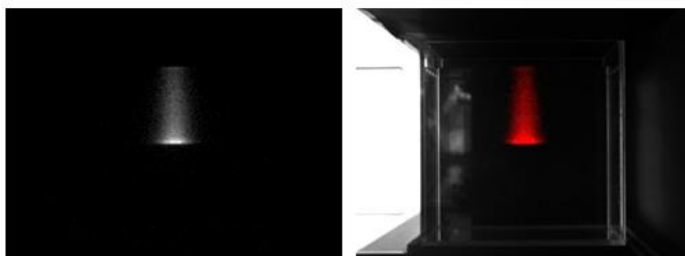
図 1 陽子線照射による水の発光画像（左）と光学写真との融合画像（右）
