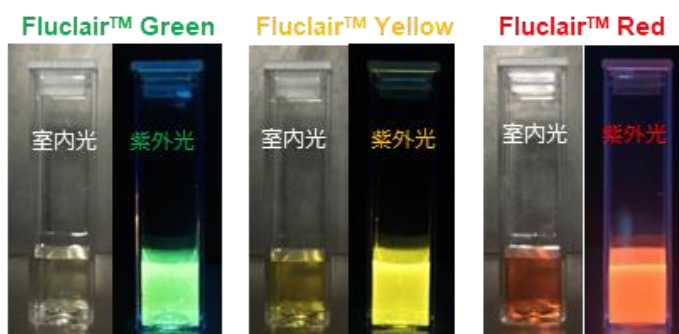
図 1. Fluclair™ Green, Yellow, Red のリン酸緩衝液中における蛍光写真
