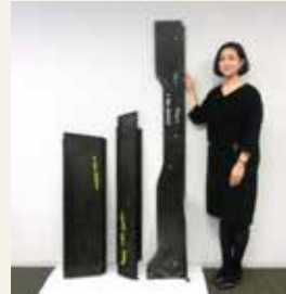
图2. 中心人员、底板和侧边梁外侧
