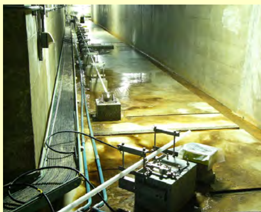
名古屋大学稲武観測点に設置されている水晶管伸縮計（左）と歪記録（右）。 (Left) Quartz extensometers in a gallery at Inabu observatory, Nagoya University. (Right) Observed strain record.
