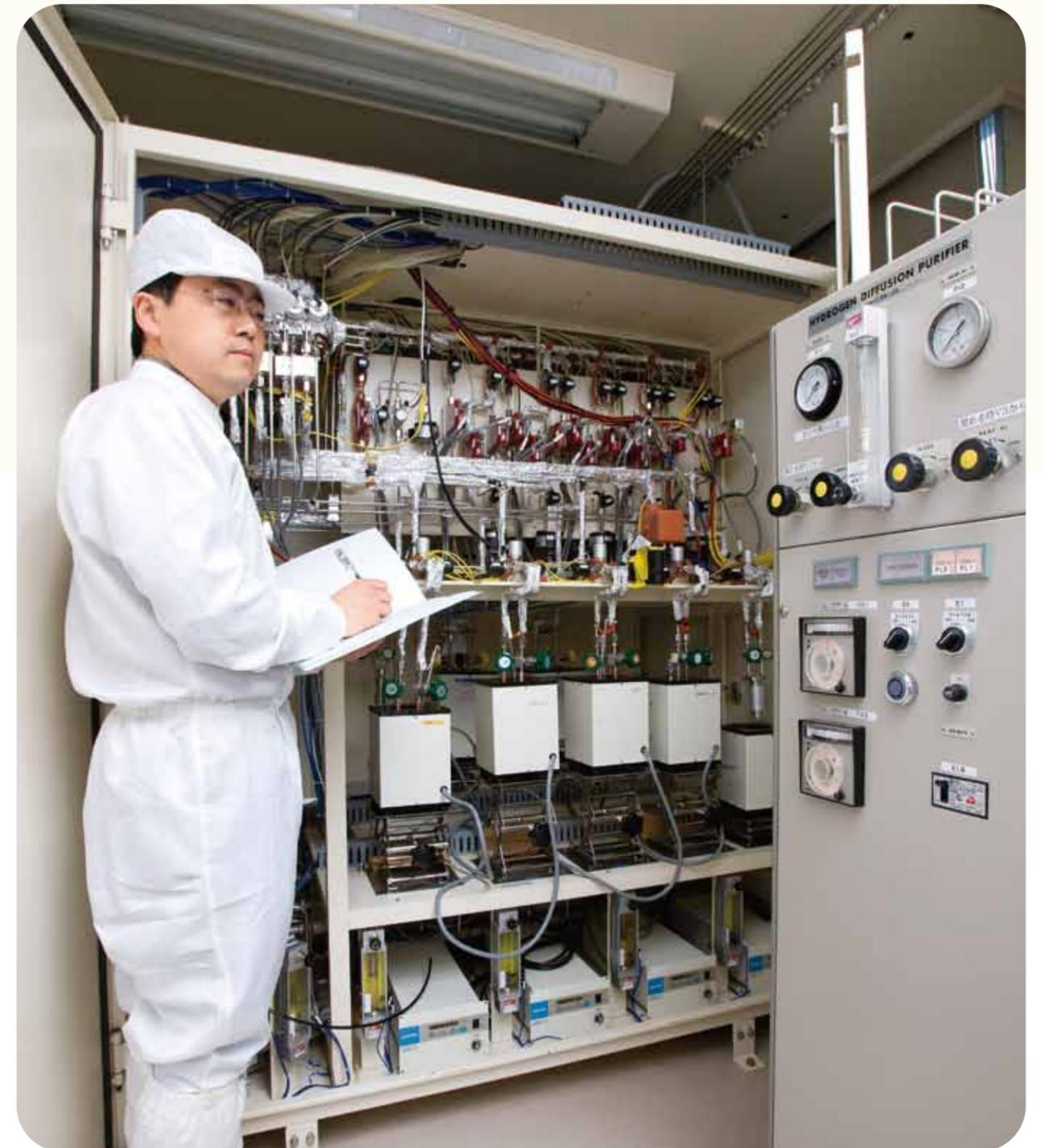
金特任助教は有機金属気相成長装置を用いて、世界最高性能を持つ半導体デバイスの作製に取り組む。
