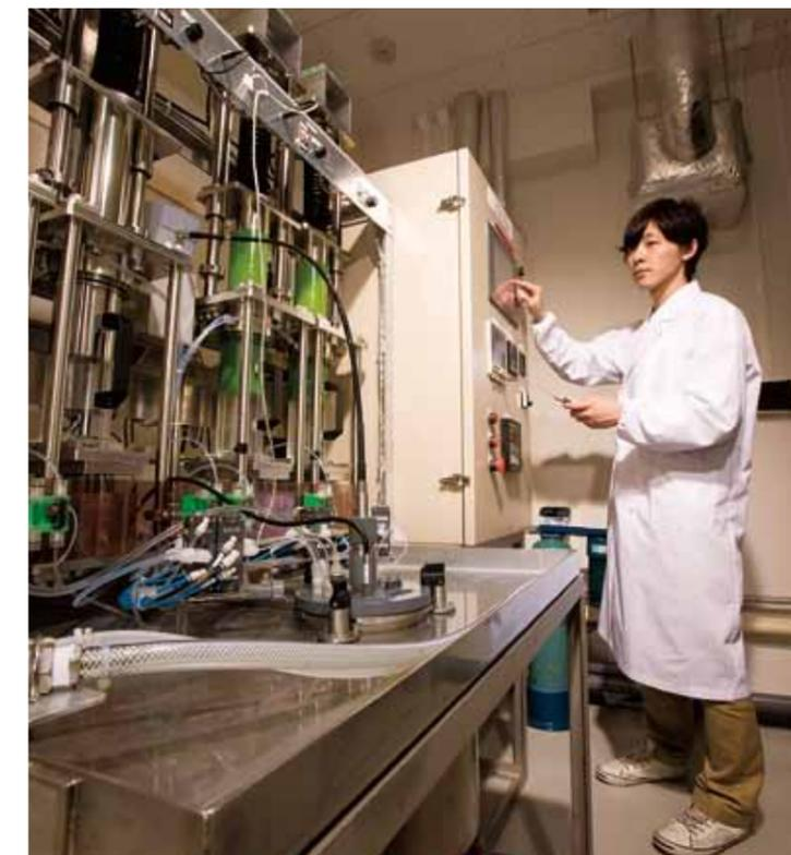
素粒子などの飛跡の検出に使われる原子核乾板を製造・開発するために、装置で作業をする中特任助教。
