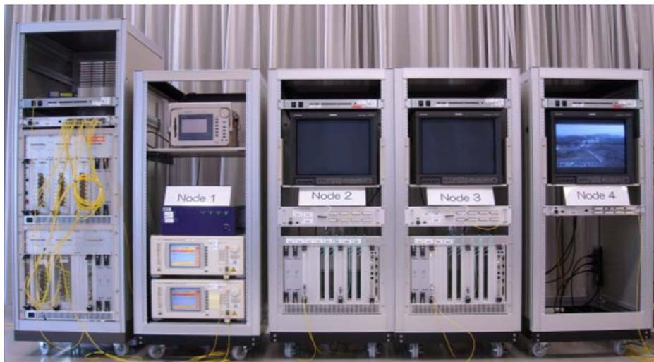
図4 多階層光クロスコネクタ装置の外観
