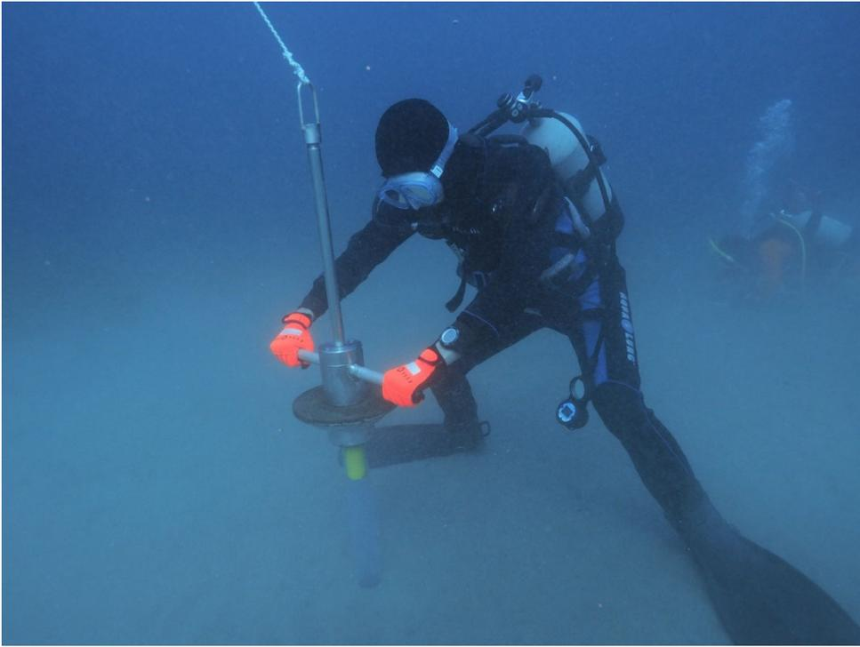
図4 水中での堆積物コアの採取の様子。手動の打ち込み機を用いて、直径6 cmのパイプを打ち込み、表層の堆積物1 m程度を採取する。
