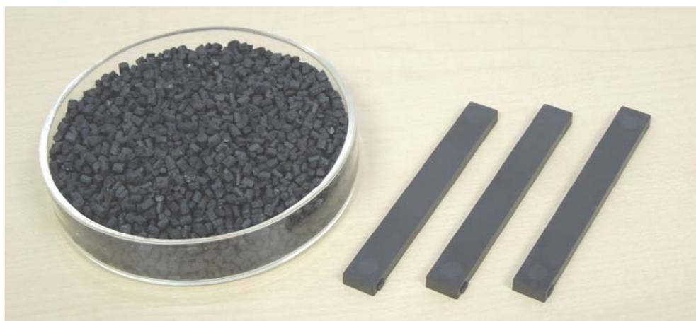
量産に成功した負熱膨張性マンガン窒化物を配合した樹脂複合材料
