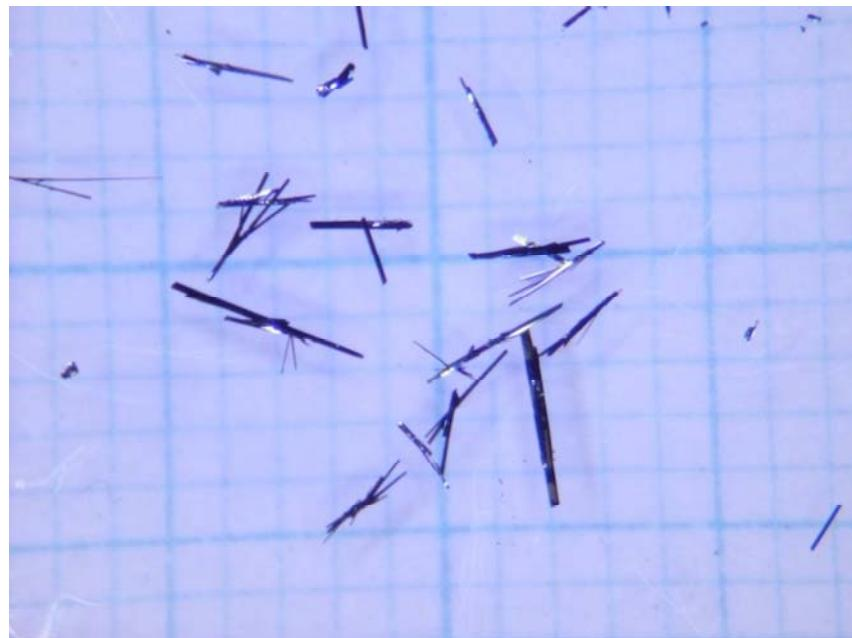
図1：測定に使用した有機化合物  $\beta$ -(*meso*-DMBEDT-TTF)<sub>2</sub>PF<sub>6</sub> の写真。数ミリ程度の長さをもった細長い形状をしている。
