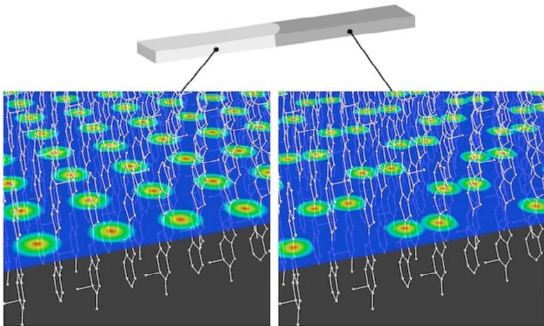
図2：有機分子でできた結晶（固相）中で、2つの異なる電子の状態が空間的に住み分けて存在している様子の概念図。SPring-8 の BL43IR の赤外顕微分光技術を利用して試料を観察した結果、同じ固相という状態であるにもかかわらず、試料の左側と右側で、電子の分布の状態が異なっていることが分かった。[左側：ダイマーモット状態と呼ばれる、電子が2つの分子（ダイマー）上に存在している状態、右側：電荷秩序状態と呼ばれる、2つの電子がペアを組むようにしてチェックカーボード型に配列した状態]
