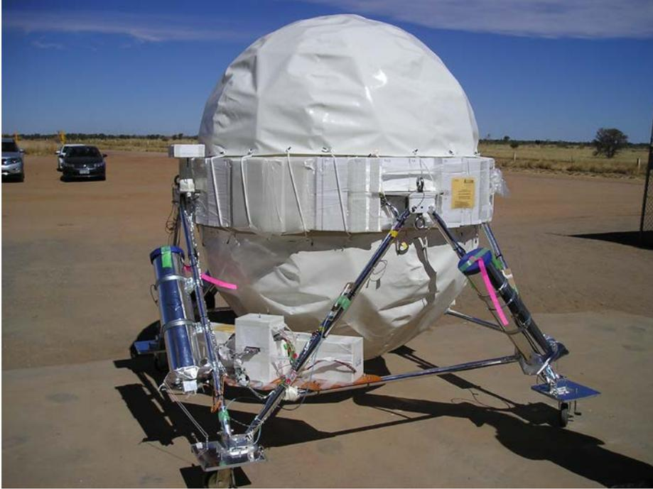
・写真2：エマルジョン望遠鏡を球形与圧容器に実装しゴンドラに搭載した姿
