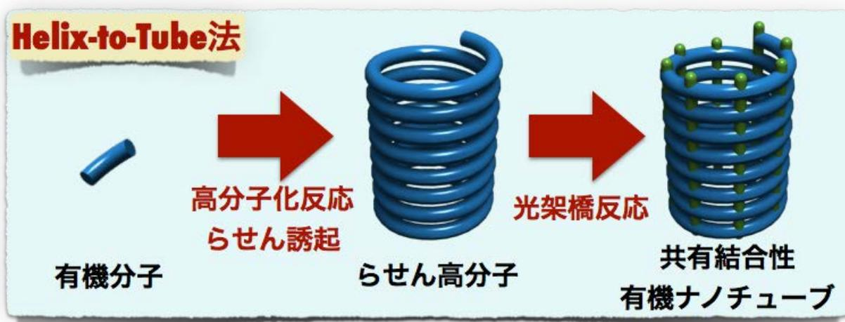
図3 本研究で開発した共有結合性有機ナノチューブの新合成手法「helix-to-tube 法」の概要
