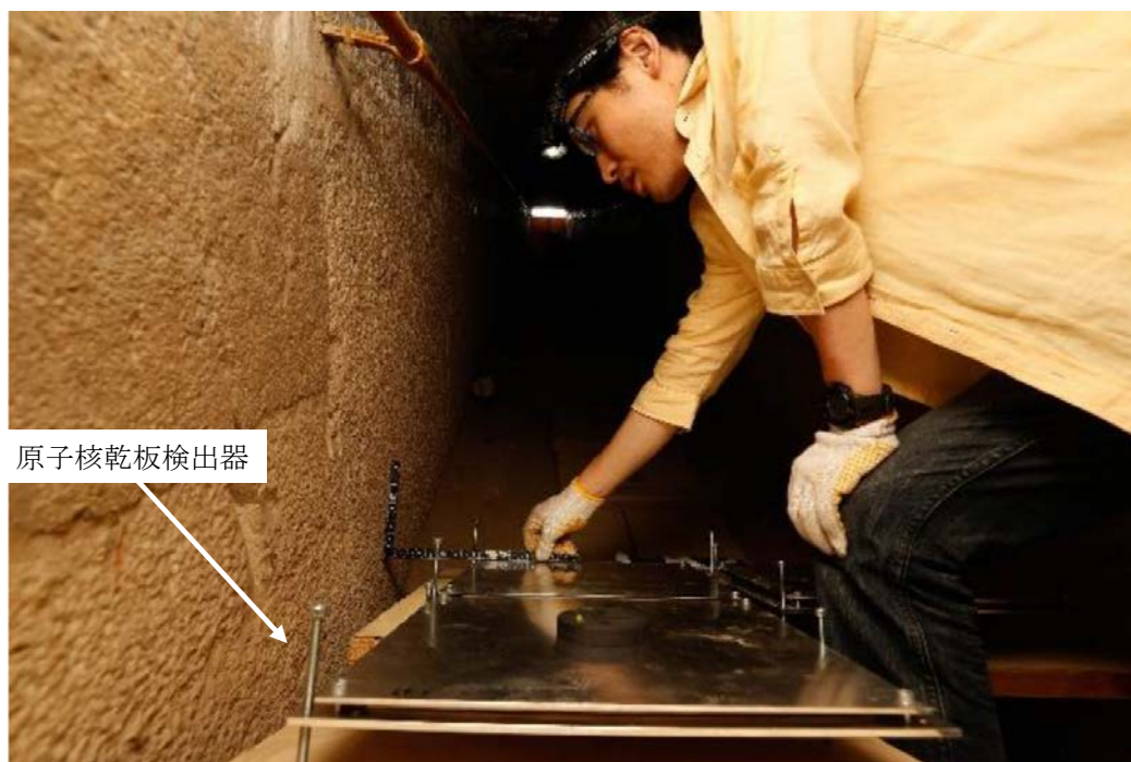
図 6. 下降通路に原子核乾板検出器を設置する様子。手前の 2 枚のアルミ板の間に原子核乾板が挟み込まれている。
