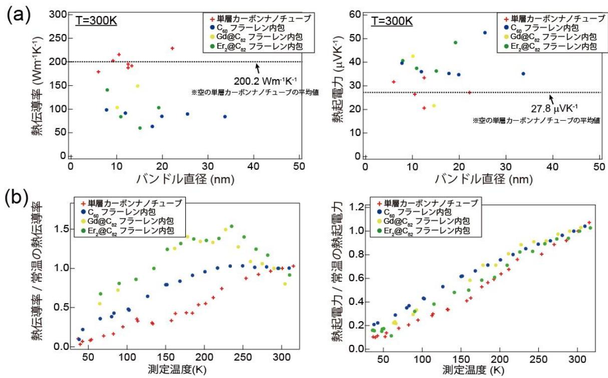
図2(a)常温における空の单層カーボンナノチューブと3種類のフラーレン内包カーボンナノチューブの熱伝導率、熱起電力の測定結果。(b)それらの温度依存性実験の結果。
