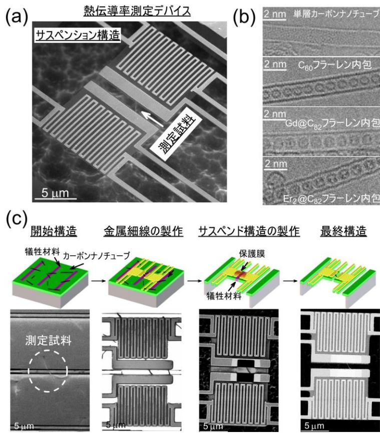
図1 (a)熱伝導率計測デバイスの電子顕微鏡像。(b)本研究で計測を行ったフラーレンを内包した単層カーボンナノチューブの透過型電子顕微鏡像。(c)本研究で開発された計測デバイスの微細加工手順を示した模式図と電子顕微鏡像。
