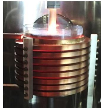
図1:カーボンのるつぼに原料となる高温金属液体を入れて、カーボンスティックの先端から高品質 SiC 結晶を成長する。このときに、るつぼやスティックを回転させたり、位置を制御したり、また液体の量やるつぼのサイズなど、様々な条件を変化させて液体中の温度分布や流れ分布を制御する。(左図)しかし、実際にはこれらの成長は加熱コイルや断熱材などで完全に覆われていて、内部を見ることもできない。(右図)
