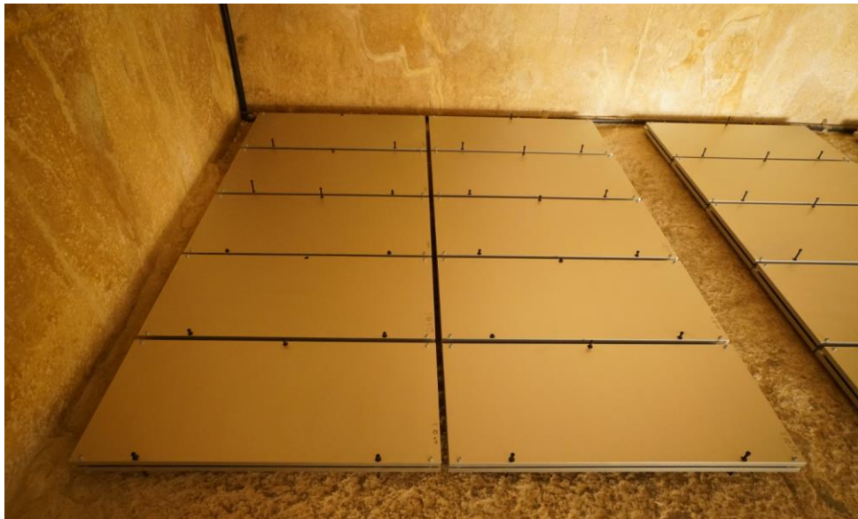
図 6. 女王の間の設置位置 1 および 2 に設置した原子核乾板検出器 設置位置 1 は縦横 1m 程度の狭い洞穴内であるため、原子核乾板 1 組を 1 組のアルミ板に固定する小型検出器を設置した 設置位置 2 は女王の間の広い床面に、できるだけ多くの原子核乾板を敷き詰めるために、1 組のアルミハニカム板の間に 3 組の原子核乾板を固定する大型検出器を大規模に設置した
