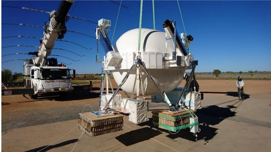
図 3: 気球実験最終準備完了時の様子。与圧容器シェルを閉じた状態。スターカメラの迷光よけフード(銀色の筒)が3方位それぞれ見える。
