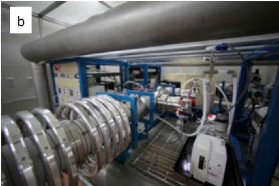
図4： かつての海水準の時期を決定する放射性炭素年代測定を行う装置。 日本で唯一、東京大学大気海洋研究所にて稼働するシングルステージ加速器質量分析装置。 (a) 全景 (b) 加速器部分拡大
