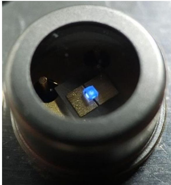
【参考画像】サファイア基板の上に作製された窒化アルミニウムガリウム LED
