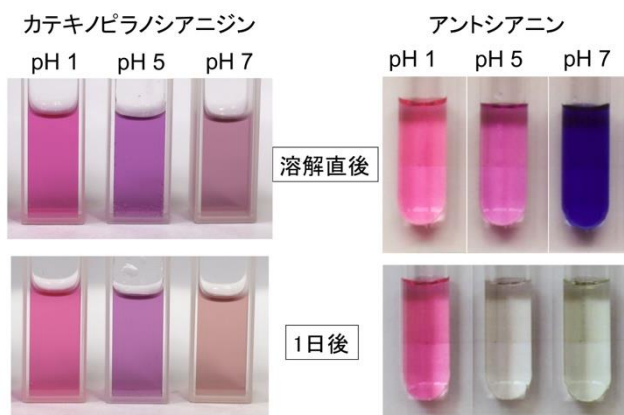
図5 カテキノピラノシアニジン(左)とアントシアニン(右)のpHによる色の違いと安定性
