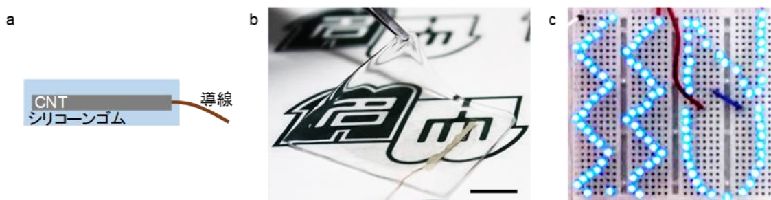
図 1 a. 発電シートの模式図 b. 発電シートの写真（スケールバーは 1 cm） c. 直列接続した 100 個の青色 LED の駆動の様子
