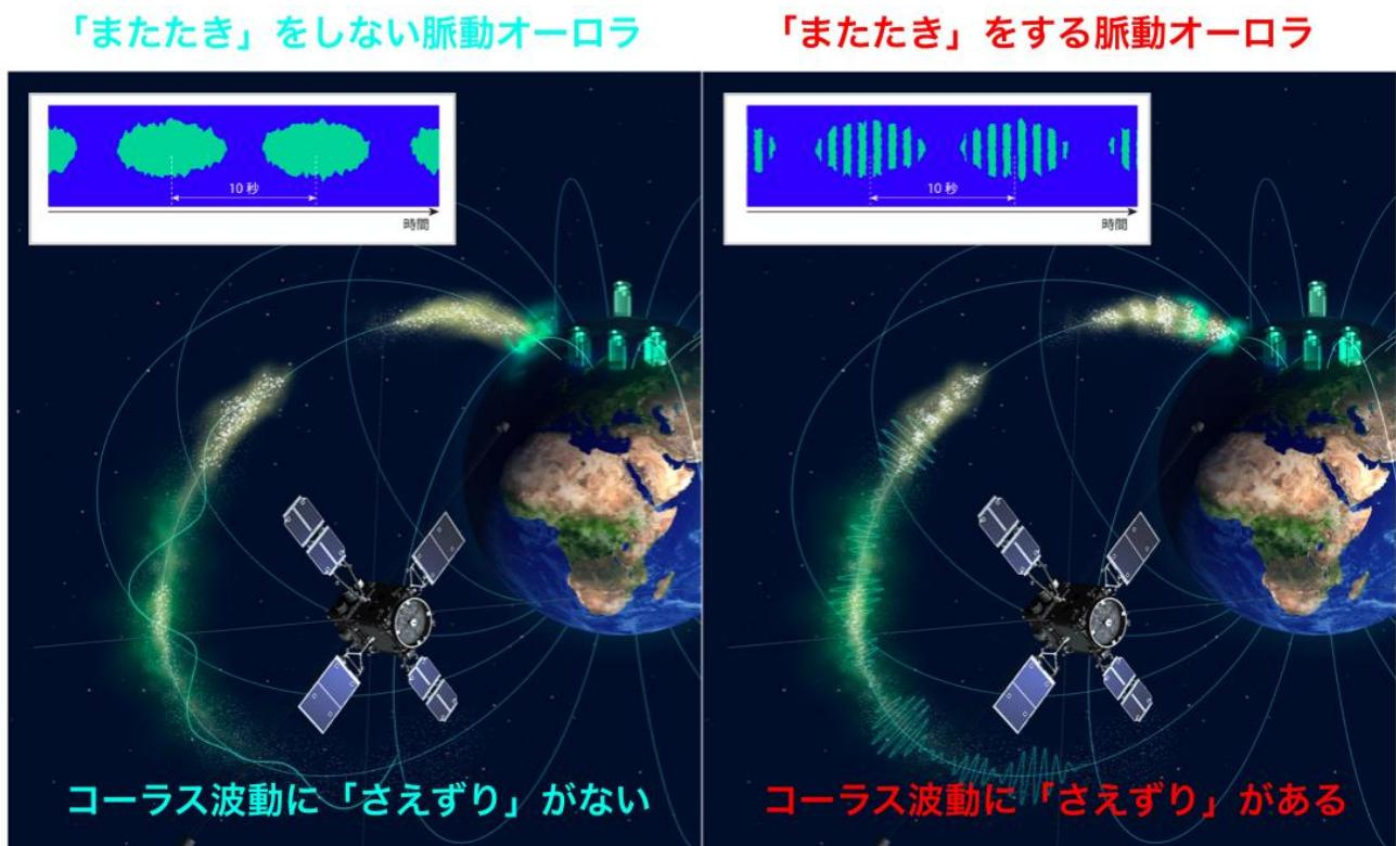
**図 5:** (左) コーラス波動に「さえずり」がない場合には、大気へ落ちている電子の量にも秒以下の時間変化がなく、脈動オーロラに「またたき」がない。(右) コーラス波動にエレメントが見られる場合は、大気へ降下する電子の量に秒以下の変動が生じ、それが脈動オーロラの「またたき」を作り出している。本研究では、この 2 つのケースを比較することで、コーラスの鳴き方（「さえずり」の有無）がオーロラのまたたきを制御していることを示した。
