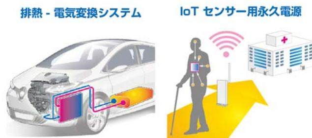
図1 熱電変換発電技術の応用例。自動車のエンジンからの排熱を電気に変換して再利用したり、人体と外気の温度差を利用して発電することによる IoT センサー用の電源としての利用が期待されます。
