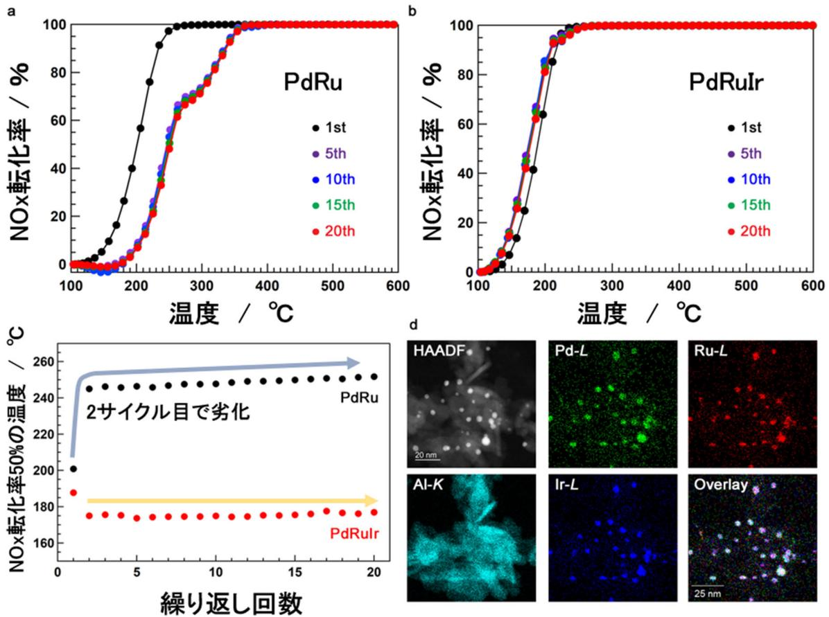
PdRu および PdRuIr ナノ合金触媒（1wt%を  $\gamma$ - $\text{Al}_2\text{O}_3$  に担持した触媒を使用）の三元触媒サイクル試験での  $\text{NO}_x$  転化率(a,b,c)と 20 サイクル後の PdRuIr ナノ合金触媒の構造(d)。PdRuIr ナノ合金は活性劣化を示さず、元素マップより 20 サイクル後も 3 元素が 1 つの粒子内に均一に存在しており、固溶体構造が維持されていることがわかる。
