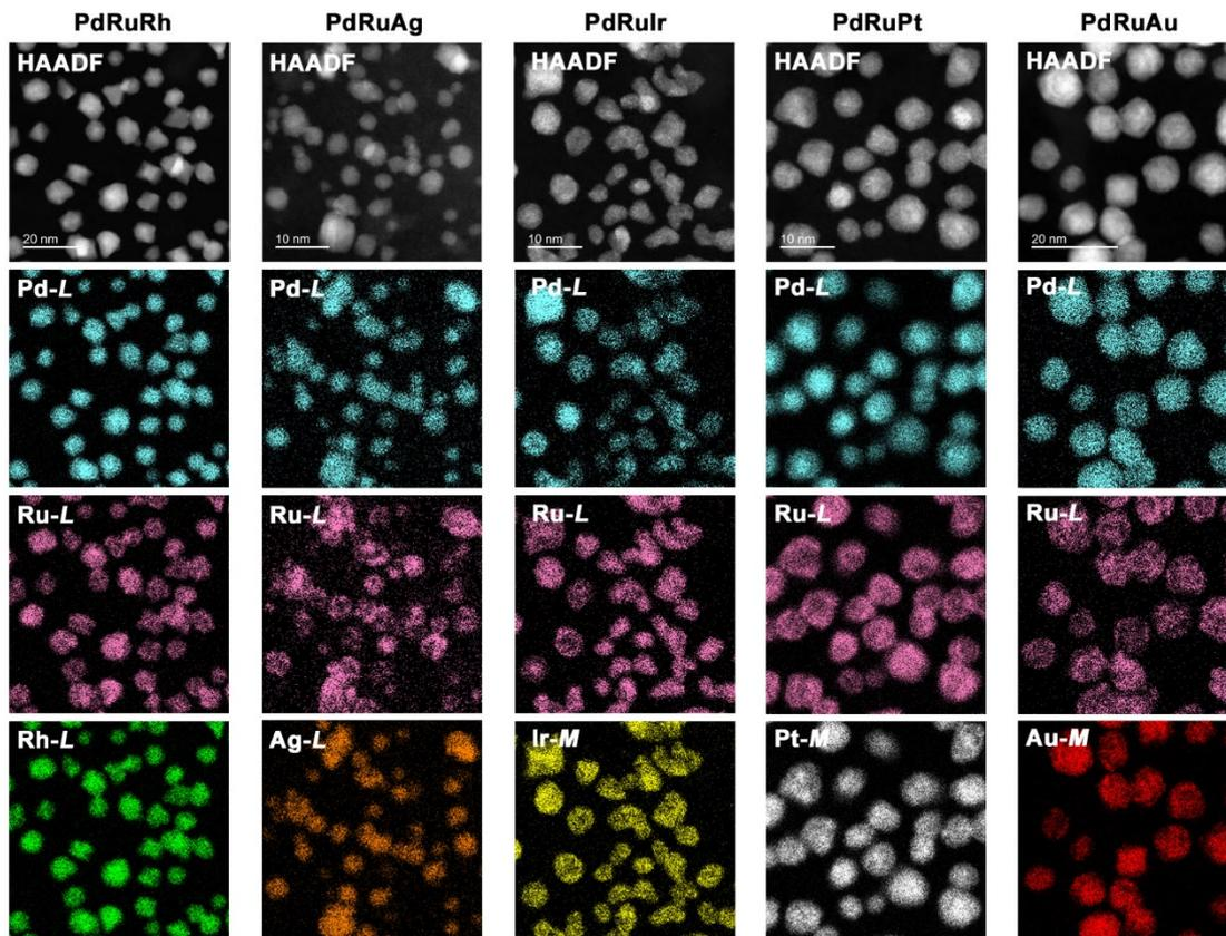
合成された PdRuM ナノ合金の走査透過電子顕微鏡法の円環状検出器による暗視野像とエネルギー分散型 X 線分光法による各元素マップ。各ナノ合金粒子内で 3 元素が混合していることがわかる。
