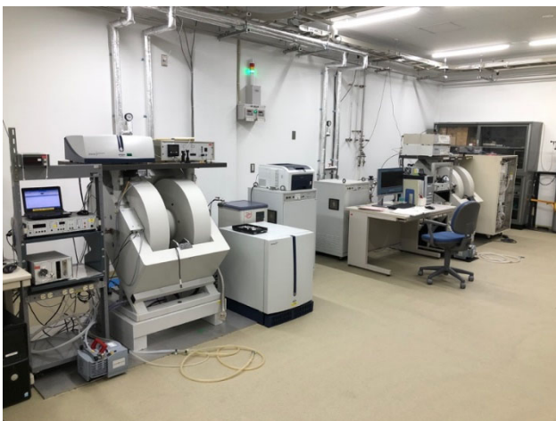
(図3) 分子科学研究所機器センターの電子スピン共鳴装置 (ESR)。右奥が今回測定に用いた Bruker 社製 E500。
