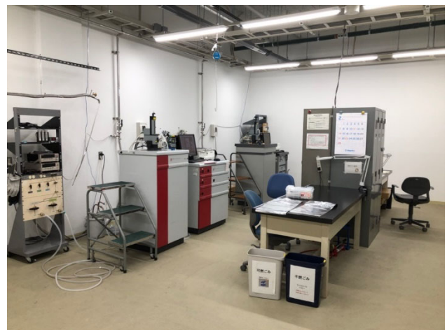
(図4) 分子科学研究所機器センターの超伝導量子干渉素子 (SQUID) 磁束計。右奥が測定に用いた Quantum Design MPMS-7。
