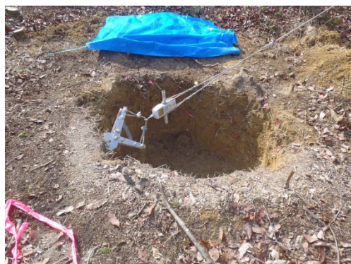
写真2 樹木根の強度試験の様子。 土壌断面に出現した樹木根を1本 ずつ引き抜き、強度を調べた。
