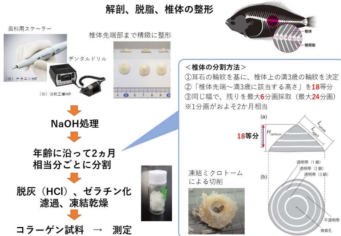
図2 精緻に整形した脊椎骨椎体を年齢に沿って分割し、コラーゲンを抽出する手順
