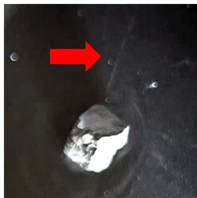
図7 方トリウム鉱からでた \alpha 線の飛跡（赤の矢印）
