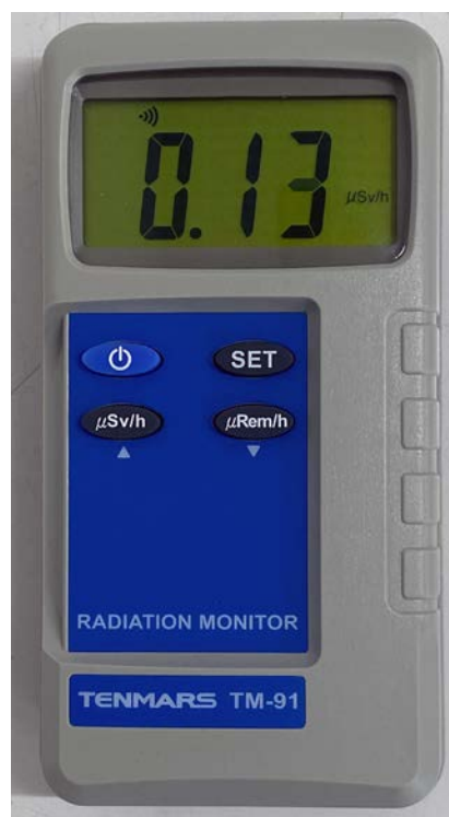
図2 実習に用いた簡易放射線測定器（テンマース製 TM-91）
