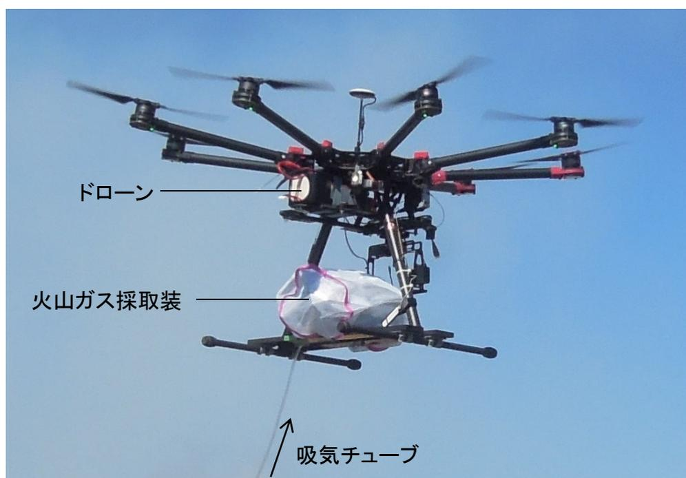
図1 開発した火山ガス採取装置を搭載して飛行中のドローンの様子。
