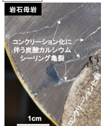
水の浸透が遮断され、風化反応が抑制（写真4）されることによります。今回の実証試験は、その理論をもとに民間の化学工業メーカーと開発した長期止水技術「コンクリーション化剤」を用いた、世界で初の実証試験であり、実際の地下350mという地下環境で、約1年間で、トンネル周辺の地下水を湧出する亀裂を段階的かつ持続的にシーリングし、透水性（透水係数）を当初の1/100～1/1000に低下させることに成功したものです。
