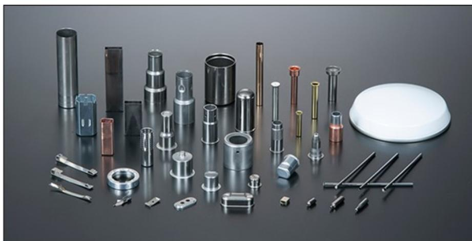
図2 プレス加工による製品例
