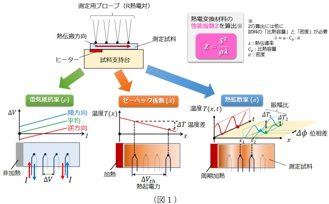
オザワ科学など3者は接触式マルチセンシングプローブ（センサー）による計測手法を新たに構築し、今までの電気抵抗率とゼーベック係数に加え、熱拡散率も測定することを可能にしました。今回開発した接触式マルチセンシングプローブは等間隔に配置された4本の熱電対プローブから構成されており、線径、接触点形状、断熱方法を最適化することで安定した信号強度と高い測定精度を実現しています。測定は薄板状の試料を端部にヒーターが組み込まれた試料支持台に置き、接触式マルチセンシングプローブを上から接触します（図1）。電気抵抗率は直流4探針法、ゼーベック係数は定常法によりそれぞれ測定されます。熱拡散率の測定には周期加熱法を採用し、ヒーターを周期的に加熱した際に試料に伝搬する熱の応答（位相差および振幅）をプローブ2点で計測し、加熱周波数の変化に伴う熱応答の変化から熱拡散率を求めます。この手法により単一試料に対して広範囲の温度帯域で測定することを可能にしました。
