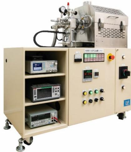
（写真＝産学連携で開発した熱電3物性を1台の装置で測定を可能とした熱電特性評価装置「OZMA-1」）
