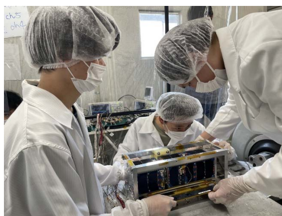
図 4 振動試験後の外観検査の様子
