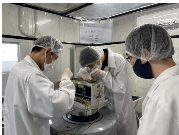
図 3 振動試験機への MAGNARO の取り付け (結合時)
