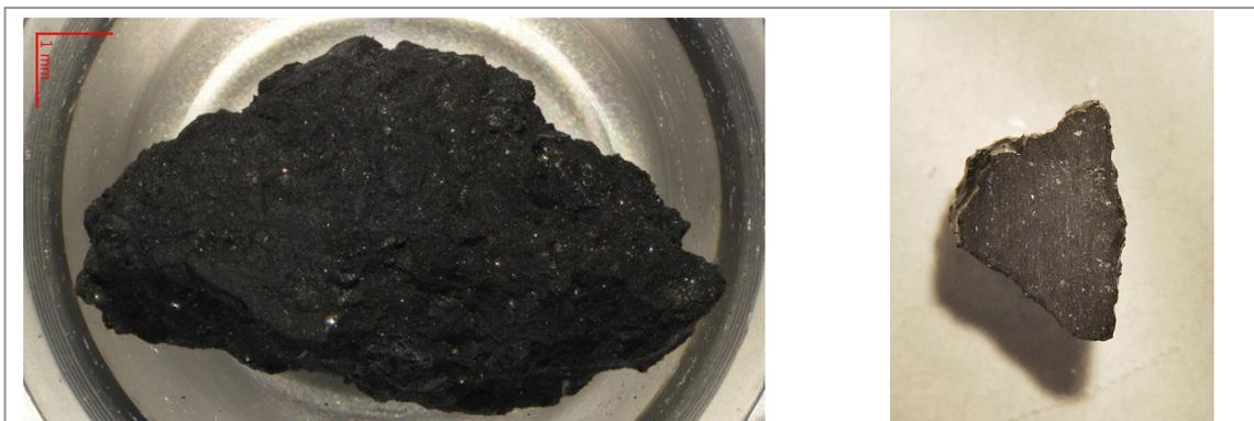
図 1 リュウグウから採取された C0002 粒子の外観写真（左：ISAS/JAXA の Hayabusa2, Ryugu Sample Curatorial Dataset より掲載、DOI:<https://doi.org/10.17597/ISAS.DARTS/CUR-Ryugu-description>）とそれから切り出された熱拡散率測定用の試験片（右）
