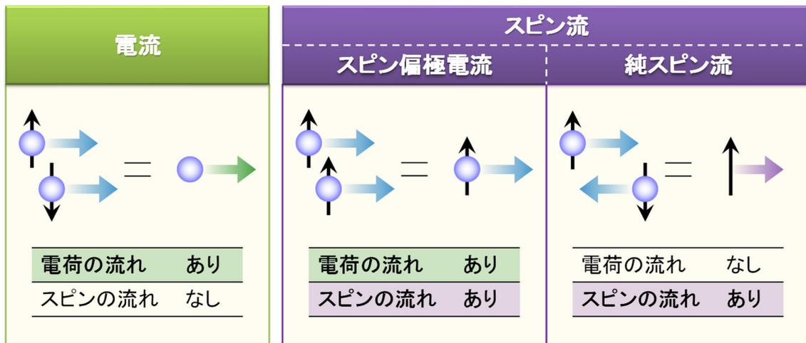
図2 電流とスピンの流れ
