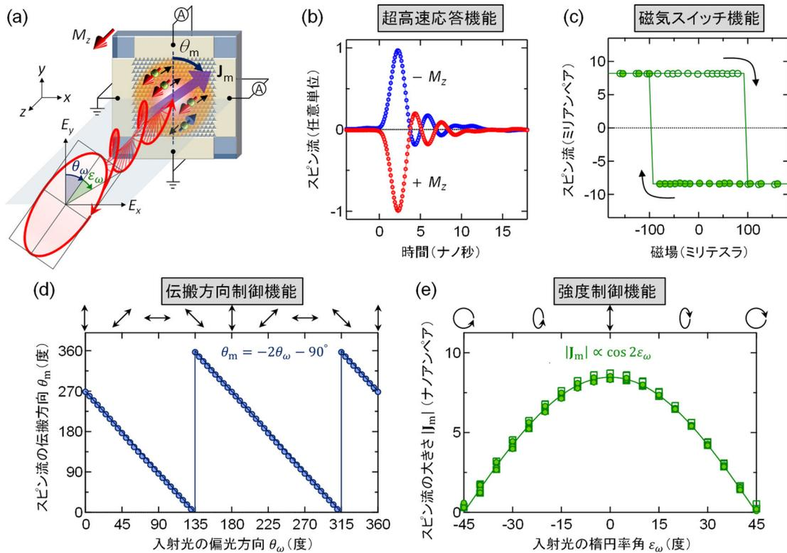
図3 磁性メタマテリアルを用いた、スピンの完全光制御の実現
