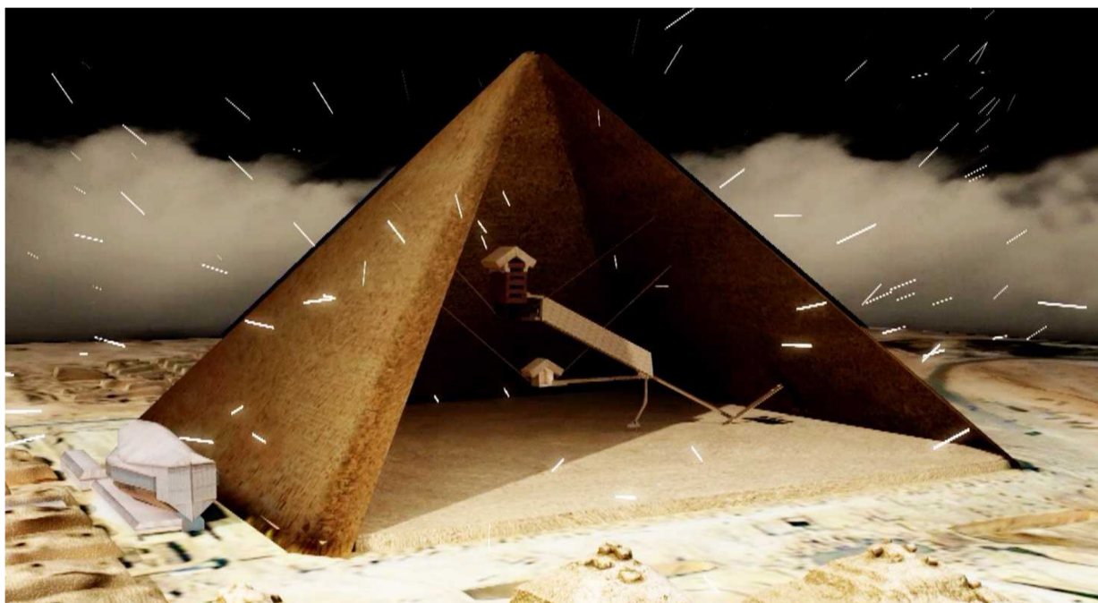
図 4:宇宙線によるピラミッド内部構造探査(ScanPyramids)
