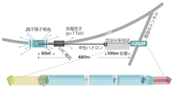
上図: CERN LHC アトラス、陽子・陽子衝突点前方480mに設置されたFASER 検出器。
