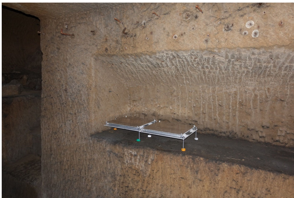
図2. 地下室に設置した原子核乾板検出器
