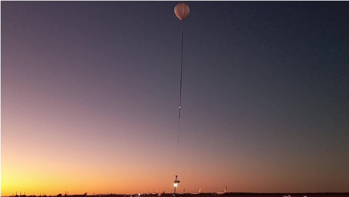
図 4：放球時の様子（現地時間午前 6:30 頃）。気球の頭部から尾部（中間発光点）まで約 130m（上空での満膨張時の体積 30 万立方メートル）。ゴンドラ重量約 1.1 トン（バラスト約 0.4 トン）、気球も合わせた総重量約 1.9 トン。
