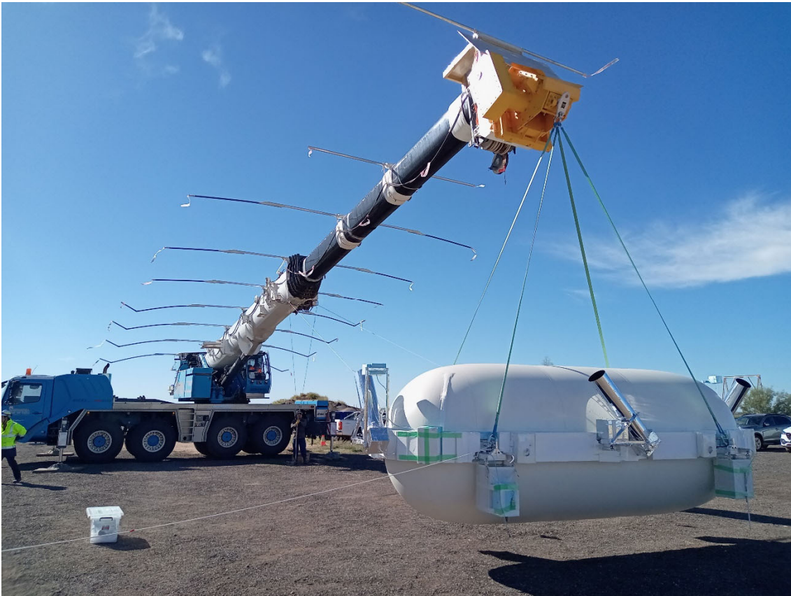
図 3：与圧容器シェルを閉じた後、最終かみ合わせ時。3 方位を向いている銀色の筒がスターカメラの迷光除けフード。
