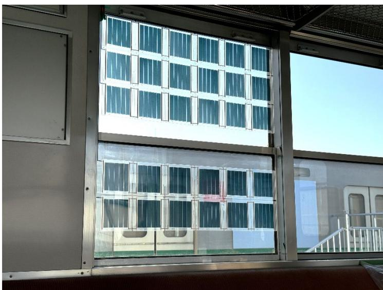
図4. 窓枠に取り付けた30枚の CNT-OPV
