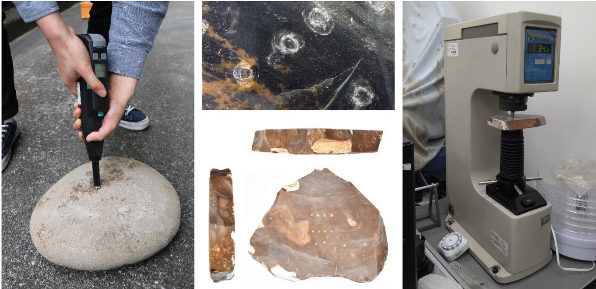
図2 本研究で採用した硬さ測定。シュミットハンマー(左)で測定すると中央上のような測定痕が出来る。ロックウェル硬さ測定(右)では岩石サンプルを中央下のようなプレート状に切断・研磨する必要がある。
