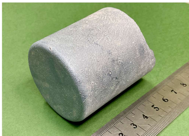
図1 φ50mm Mg_2Si バルク結晶体
