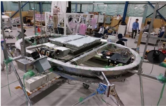
図 3：2018 年気球実験エマルジョンガンマ線望遠鏡（与圧容器を閉じる前）。与圧容器リング内側（短手方向 1.5m）に多段シフターを搭載し、その上にエマルジョンフィルムパックを搭載している。エマルジョンフィルムは 1 ユニットあたりの大きさが 37.8cm×25cm、厚み方向に 113 枚積んでいる。それらを 4 ユニット並べ、口径面積 3780cm<sup>2</sup>を実現している。与圧容器リング外側には 3 方位を向いたスターカメラのレンズ（黒）が見える。
