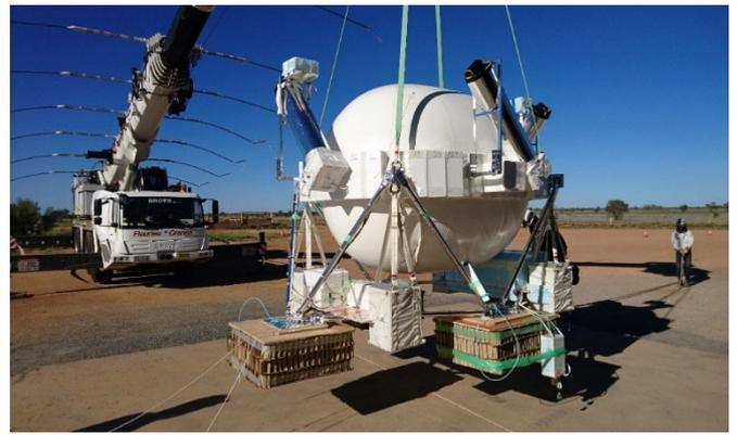
図 4：2018 年気球実験エマルジョンガンマ線望遠鏡（与圧容器を閉じた後）。スターカメラの迷光よけフード（銀色の筒）が 3 方位それぞれ見える。
