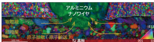
ナノワイヤ付薄膜断面のSTEM-EBSD像
