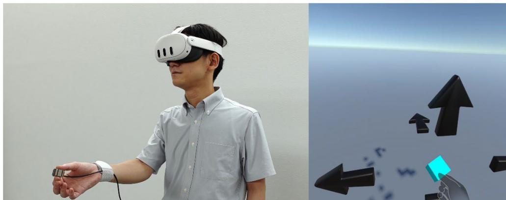
図 5 VR ヘッドセット(Meta Quest 3)と XReactor を組み合わせた力触覚体験
